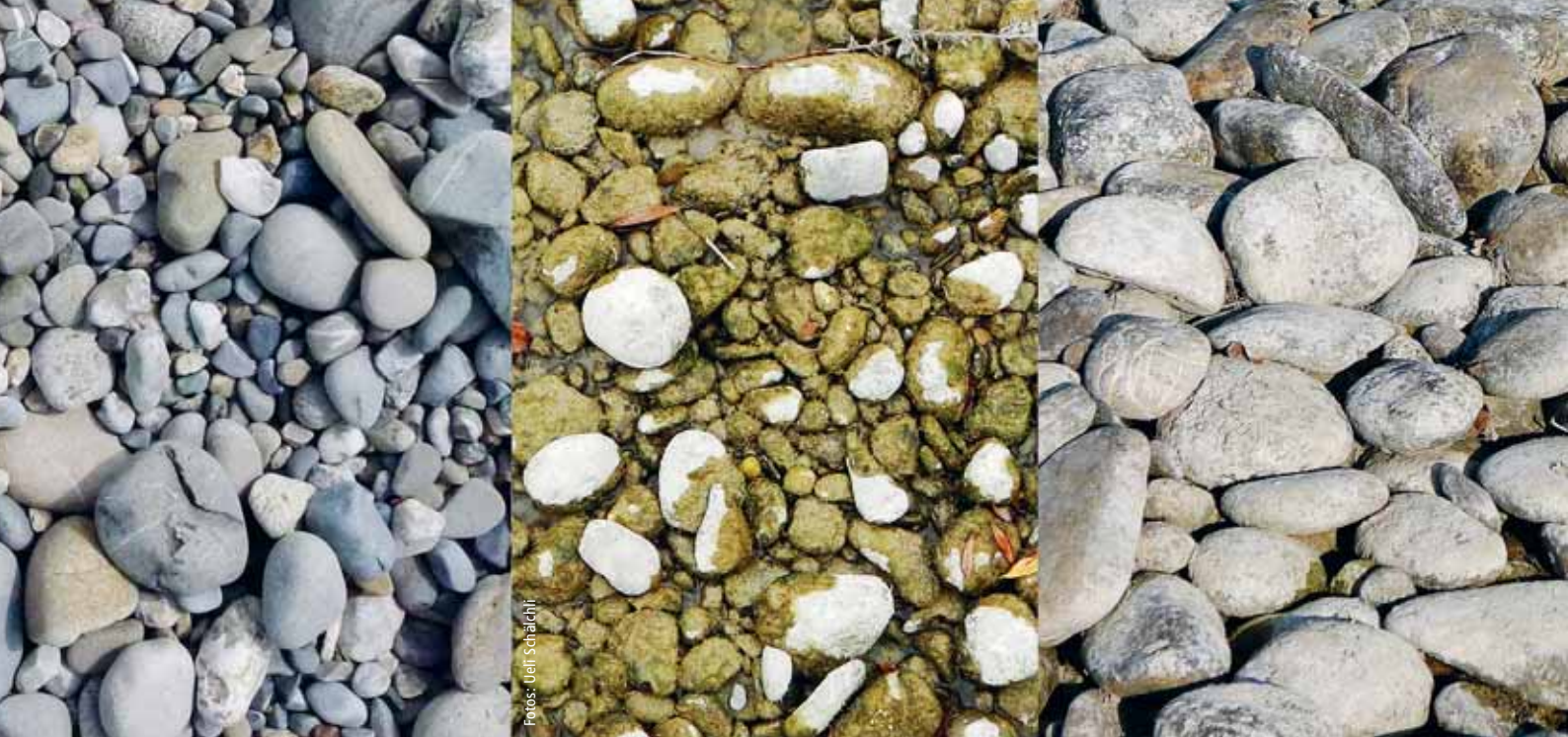
▲ Bild 2: Frische Geschiebeablagerungen (links) und kolmatierte Geschiebeablagerungen (Mitte). Das Bild rechts zeigt eine grobe und abgeplästerte Sohle (Deckschicht).
